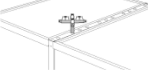
Rubinetto quadruplo bifronte RB 602 - gas RB 607 - vuoto RB 612 - azoto RB 617 - aria compressa
